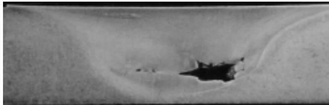
接合材の裏面付近に発生する空洞上の欠陥でツールの回転数が少ないなどの摩擦熱が小さい場合に発生する。
