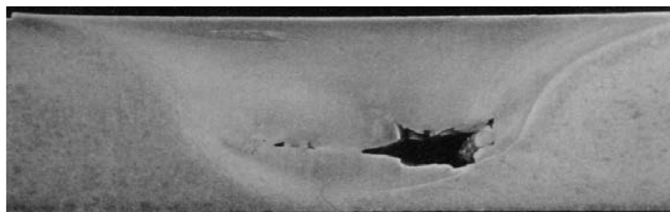
攪拌不足空洞欠陥
